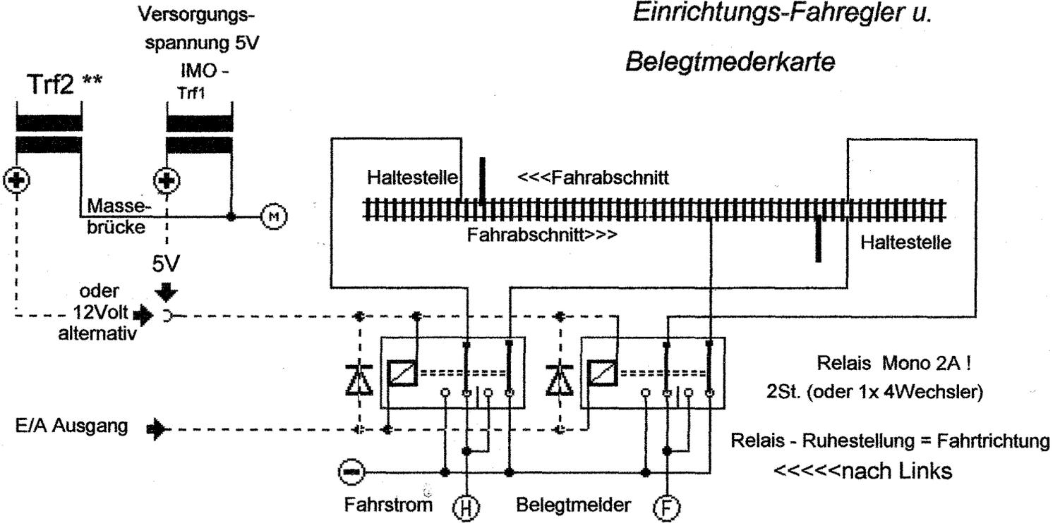
\*\*Sollen Relais mit anderen Spannungen verwendet werden, kann dies durch das erweitern mittels eines zweiten Transformators -wie oben abgebildet- ermöglicht werden.
